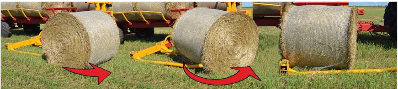
La zampa idraulica universale in movimento apre il rotolo e lo carica sulla piattaforma
