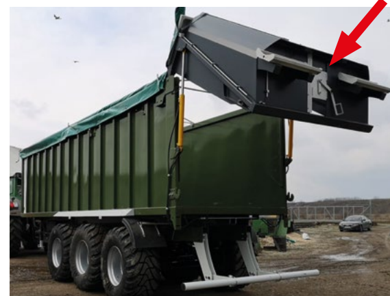
Valvola posteriore per lo scarico del grano
