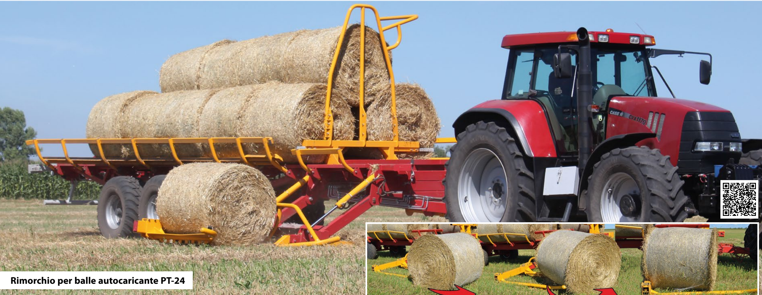
La zampa idraulica universale in movimento apre il rotolo e lo carica sulla piattaforma
