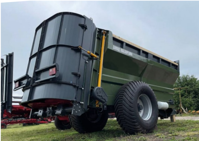
Parete posteriore con apertura idraulica
