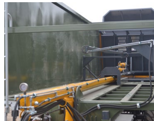
Sistema idraulico della parete mobile
