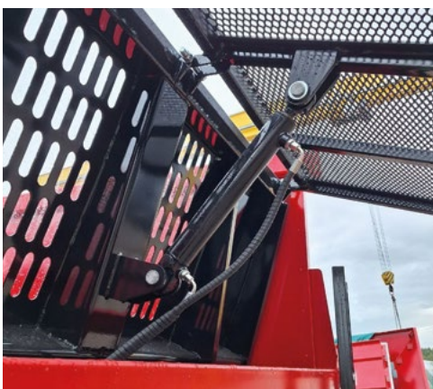
Rete ad apertura idraulica su parete scorrevole
