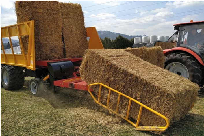
Il peso massimo della balla è di 750 kg
