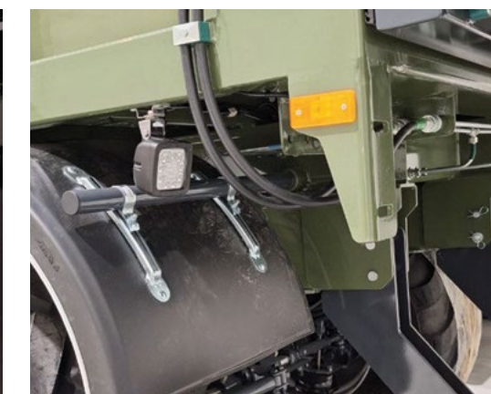
Luci LED laterali e posteriori per illuminare la pista tecnologica in campo
