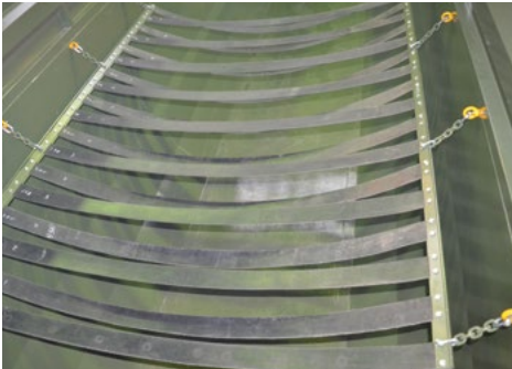
Kummivöödega amortisaator kartulite pehmeks mahalaadimiseks
