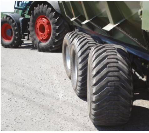
Esimene ja viimane telg on positiivselt juhitud
