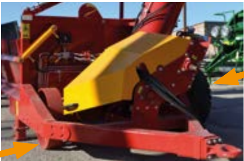
Opțiune suplimentară de roți din față pentru transportul cerealelor în buncărul mașinii BNP
