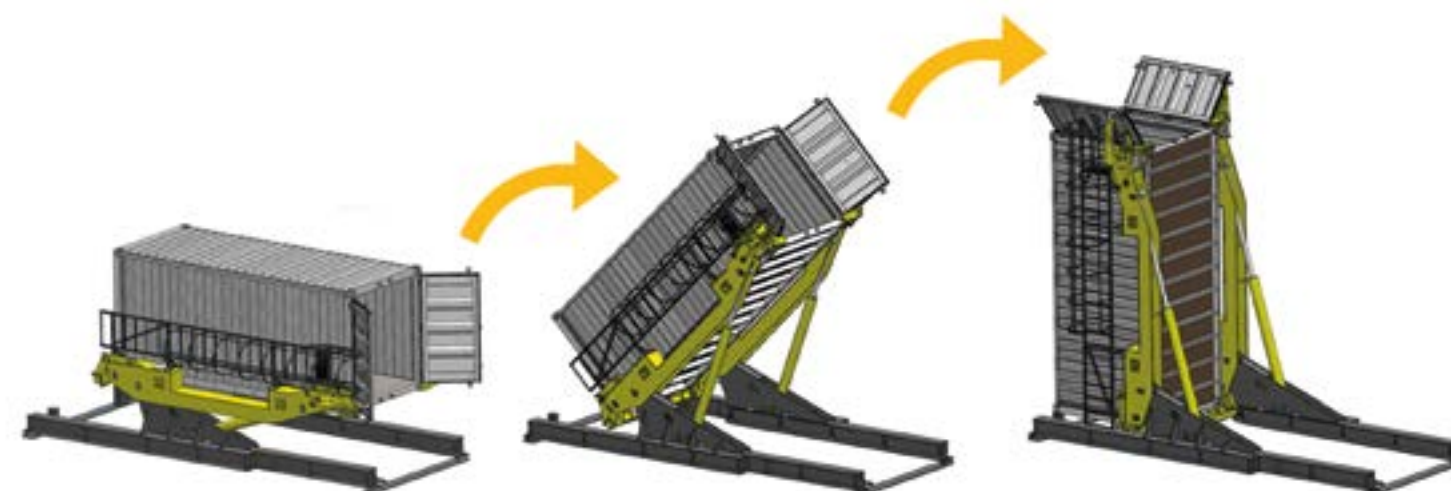
procesul de basculare a containerului
