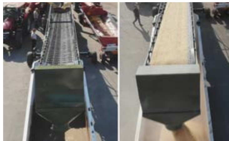
Banda chevron în formă de V de 1 250 mm nu deteriorează semințele
