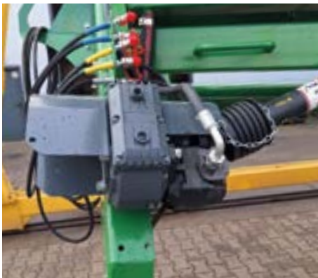
Stație petrolieră autonomă pe ZRM-180. Pentru a crește debitul de ulei pe motorul hidraulic.
