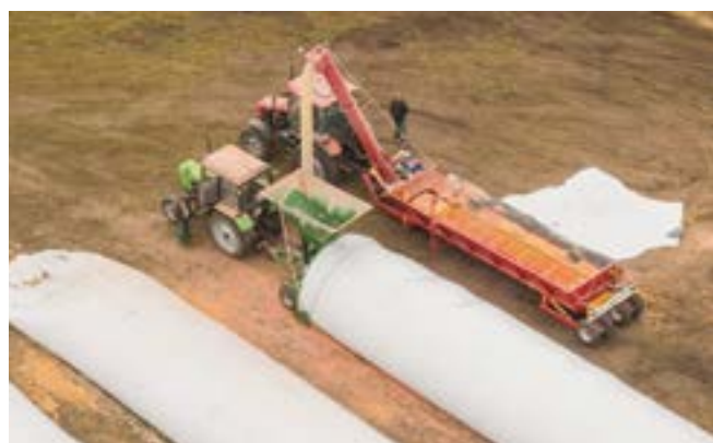
Utilizarea BNP-12 «Kovheg» pentru furnizarea de cereale în ZPM-180
