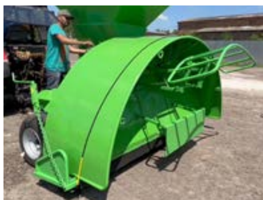
Ridicarea/coborârea cadrului pe care măneci minciuni - cu un troliu
