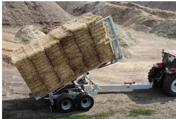
Paalipuoliperävaunun purkaminen tasaiselle ja kiinteälle alustalle kestää 30-40 sekuntia.
