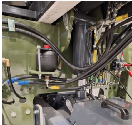
Vetoaisa hydraulisella korkeussäädöllä ja hydraulisella iskunvaimentimella sekä hydraulisella akulla.
