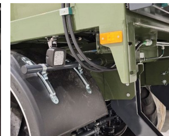
Sivu- ja takaosan LED-valot valaisevat teknologista rataa kentällä
