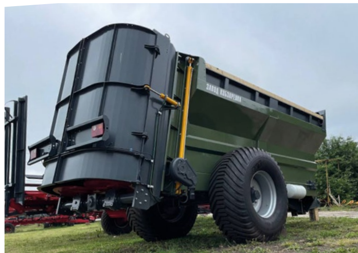
Takaseinä avataan hydraulisesti
