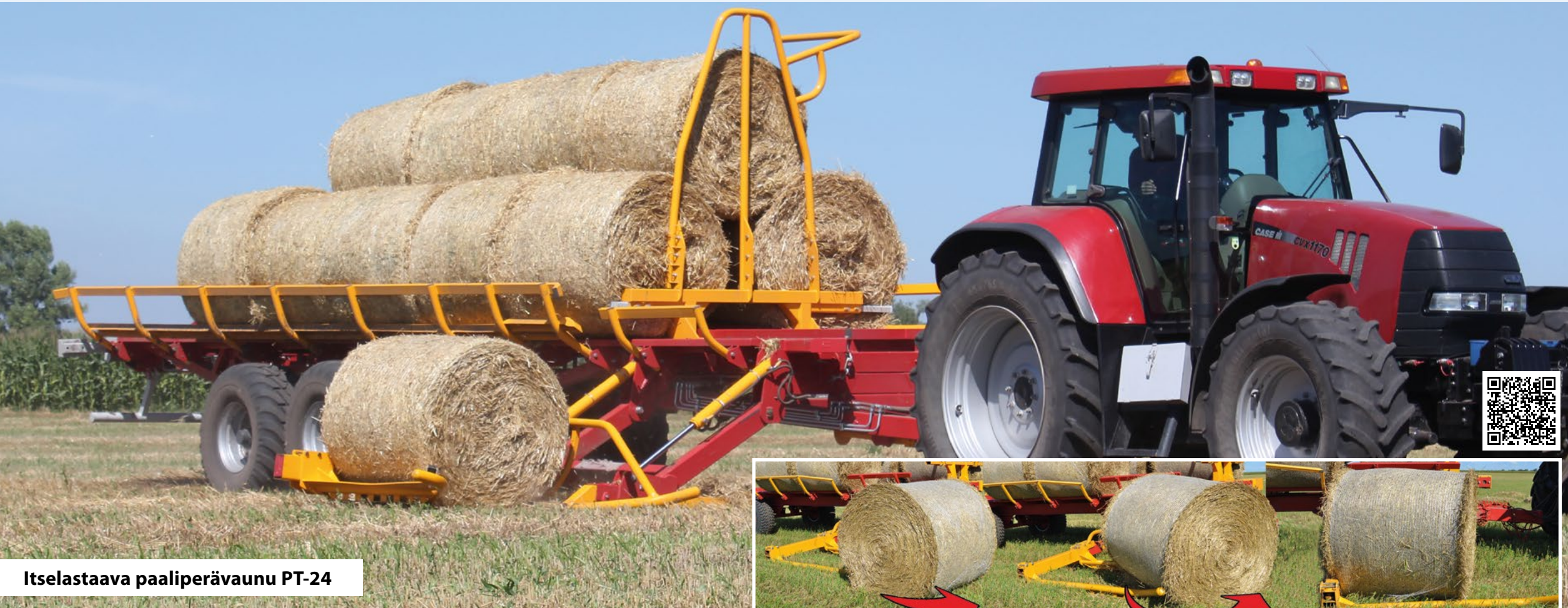
Yleiskäyttöinen hydraulinen käpälätoiminto purkaa rullan ja lataa sen lavalle.
