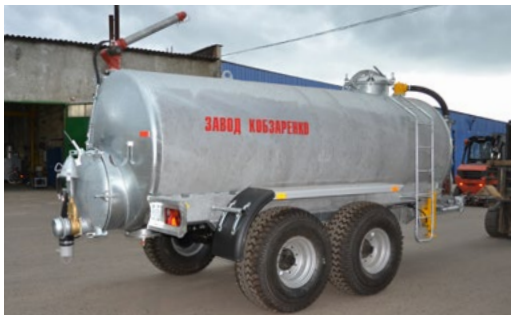
Kuumasinkitys. Sinkkikerros 100–300 mikronia
