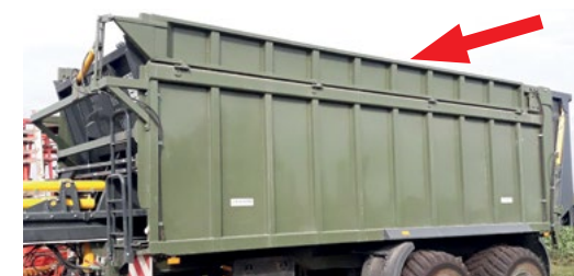
Hydraulinen sivusuunnassa avautuva h-400 mm
