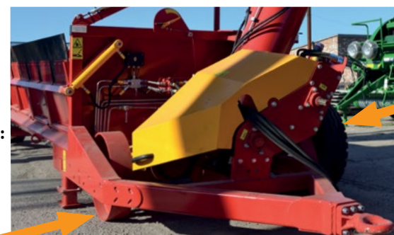
Lisäetupyörät viljan kuljettamiseen BNP-koneen suppilossa
