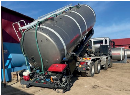
RZS:n asennus kuorma-autojen alustaan
