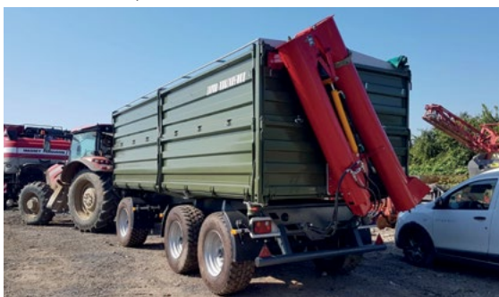
Takaseinä on sovitettu uudelleenlastausta varten.
