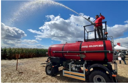
Palotynnyri PC-6. V - 6 m 3 Nesteen ruiskutus jopa 30 metrin etäisyydelle Varustettu pumpulla (toimii traktorista) tai moottoripumpulla (toimii paikallaan)
