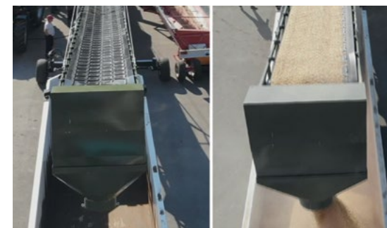
V-muotoinen chevron-hihna 1 200 mm ei vahingoita siemeniä
