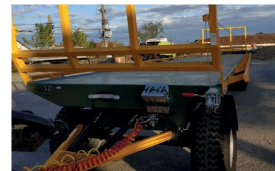
Vinssi ja alustan leventäminen 3 metriin
