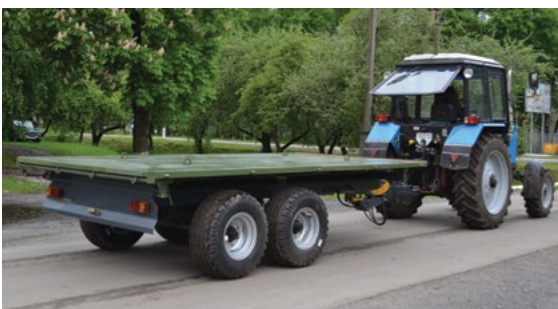
Kolmisuuntaiset purkausperävaunut voidaan helposti muuttaa tavanomaisiksi lava-autoiksi.
