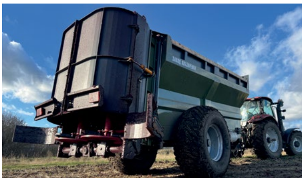
Hydraulisesti avattava takaseinä
