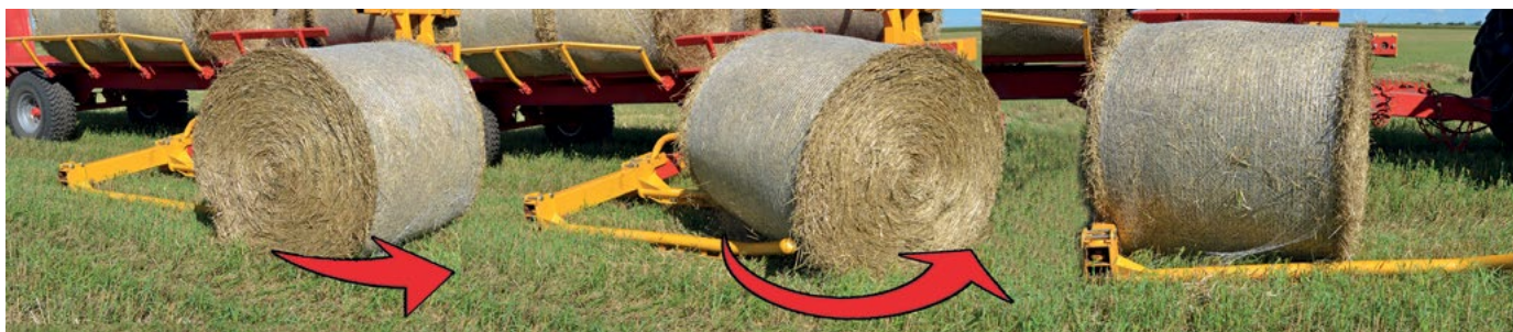
Yleiskäyttöinen hydraulinen kynsi avaa rullan ja lastaa sen lavalle
