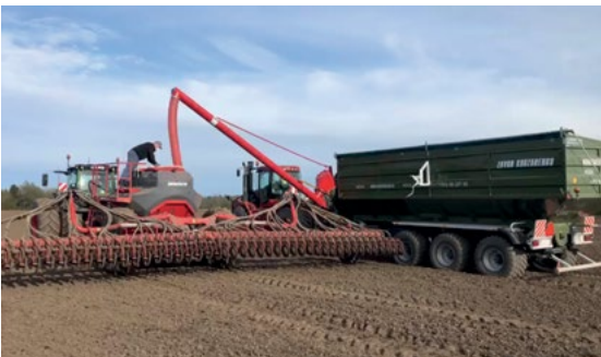
ShRP-jatkoruuvi kylvökoneiden lastaamiseen
