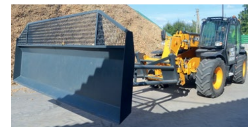
Teleskooppikuormaajan jatke viljan, säilörehun, hakkeen ja lumen kasaamiseen
