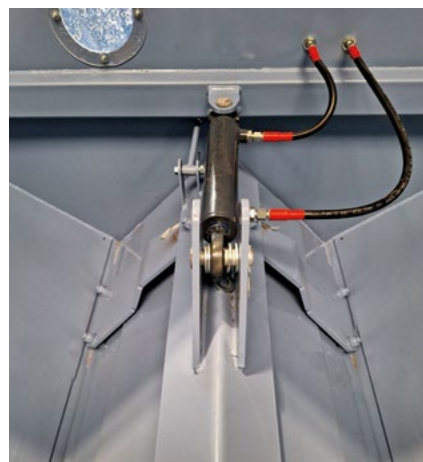
HYDRAULINEN AVAUSLAIPPA: SYÖTTÄÄ VILJAN RUUVIIN.
