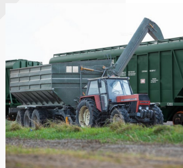
PIDENNETTY 5,5 METRIN KORKUISEN RUUVI VAUNUIHIN KUORMAAMISTA VARTEN.
