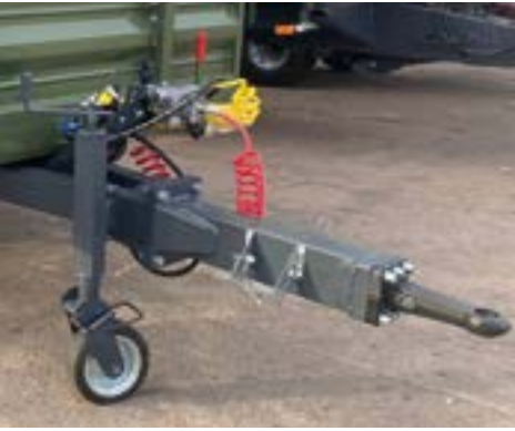
Suport mecanic pentru bară de tracțiune cu roată TSP-6t
