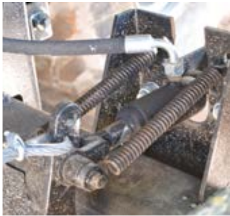
Sistem hidroauihc de franare
