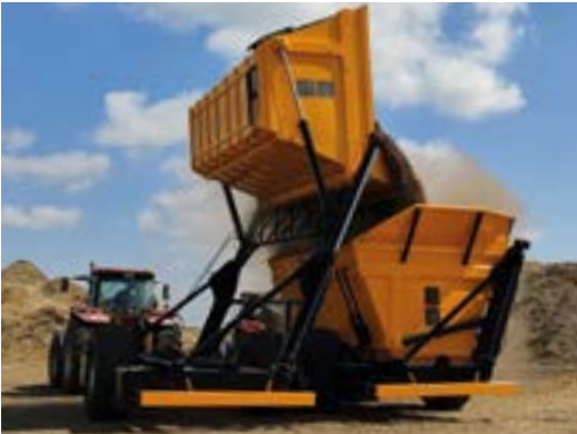
Înălțimea maximă de descărcare este de 4.000 mm
