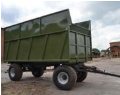
2TSP-14 suport de cip cu un volum al corpului de 24 m³
