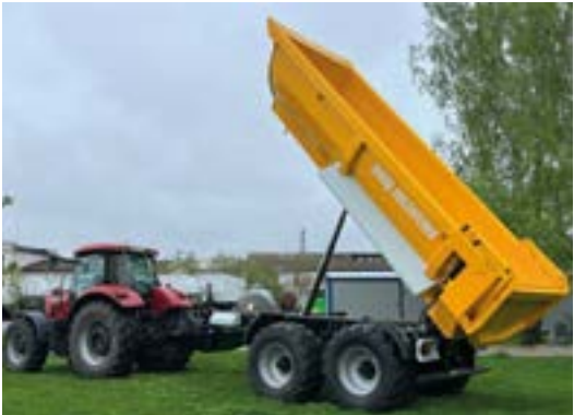
Cilindru hidraulic telescopic DiNatale (Italia)
