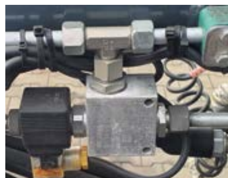
Supapa hidraulica pentru blocarea deschiderii portii culisante la priza de putere fixa
