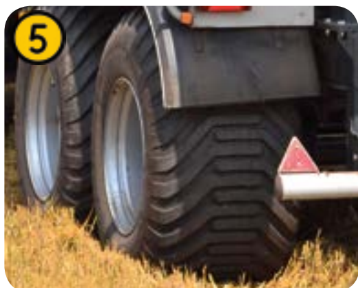
Dimensiunea maximă a roții 850/40R26.5 - Presiune minimă la sol 1,5 kg/cm 2
