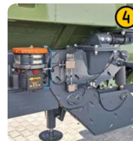
Calculator programabil cu interval precis de lubrifiere a rulmenților
