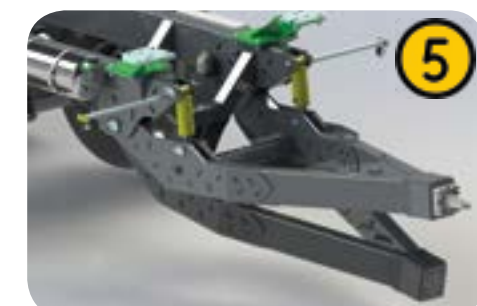
Bara de tracțiune reglabilă hidraulic
