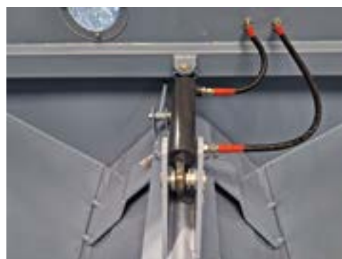
O poartă glisantă care se deschide hidraulic. Se alimentează cu cereale melcul .
