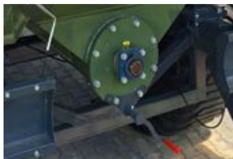
Mecanism cu șurub de deschidere orizontală clapeta de curățare a melcului
