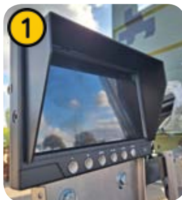
MONITORUL CAMEREI DE VEDERE SPATE
