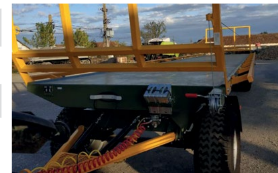
Verricello e allargamento piattaforma a 3 m
