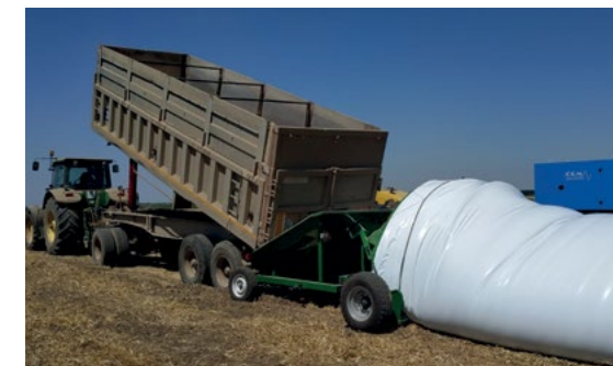
ZPM (A) -180 con tramoggia ribassata e motore elettrico. Caricamento da un'auto.
