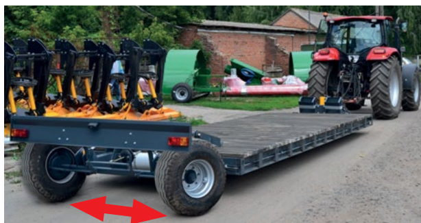
Piattaforma a basso profilo NP-7 con ruote sterzanti
