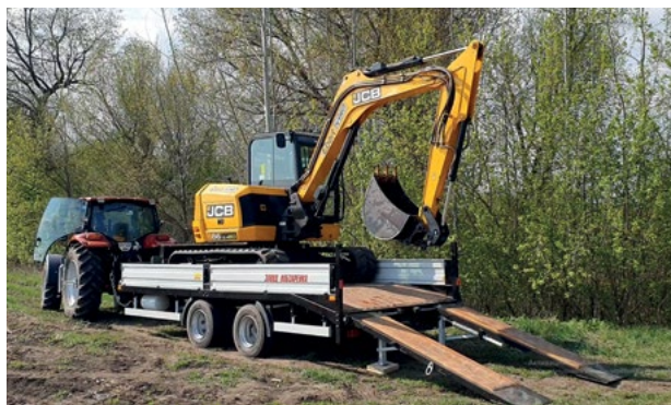
Rimorchio per il trasporto di attrezzature speciali fino a 9 tonnellate
