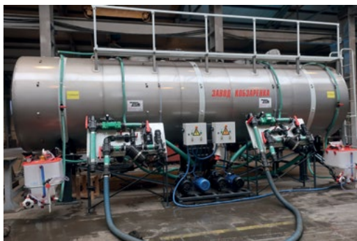
Unità di malta stazionaria RZS-20 con due scomparti indipendenti
