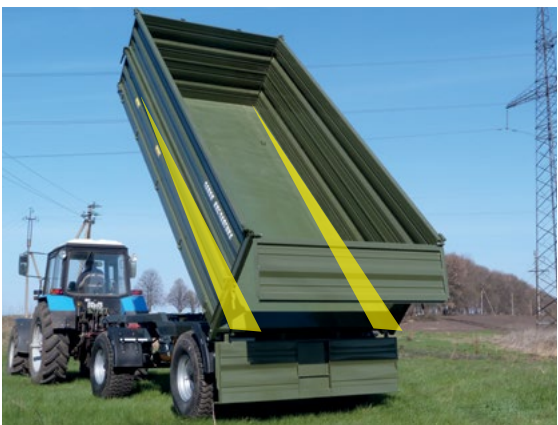
Il corpo conico impedisce la sospensione della massa verde e fertilizzanti
