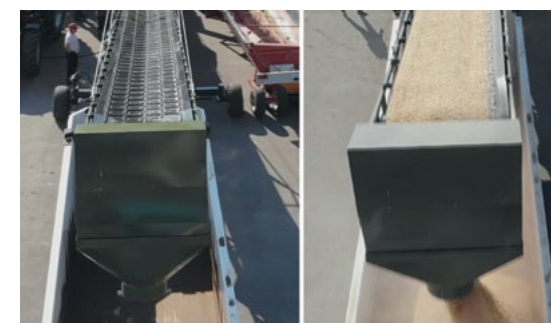
La cinghia a V chevron da 1.200 mm non si danneggia i semi
