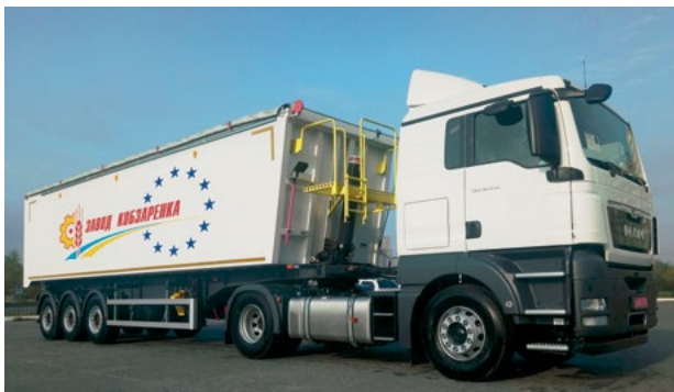
Semirimorchio ribaltabile in alluminio. Modello 50, 55, 90 metri
