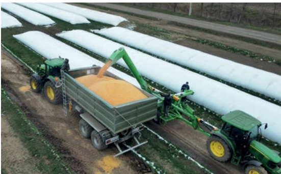
Scarico del grano dal sacco utilizzando lo ZRM-180
